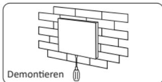
Stecken Sie einen Schraubendreher in das unten stehende Bajonett und einen Schraubendreher nach oben, dann können Sie den Controller demontieren.
