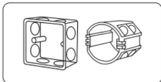
Installieren Sie das untere Gehäuse in der Wand; Oben sind die Standard-Unterteile.
