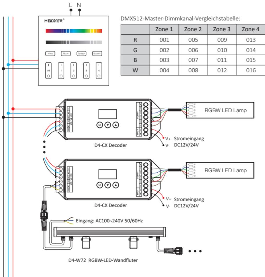
Stellen Sie nach dem Verbinden mit dem DMX-Decoder oder der DMX-Lampe die Adresse des DMX-Decoders oder der DMX-Lampe wie folgt ein:
